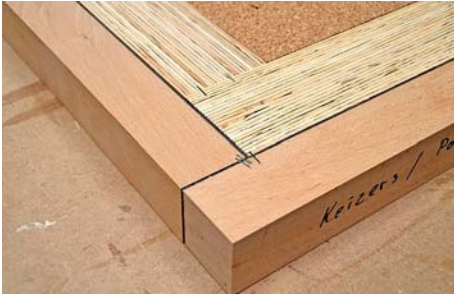
/ Der Türrohling mit Verstärkungsrahmen und Buchen-anleimern mit dem Aufschäummaterial Promaseal.
