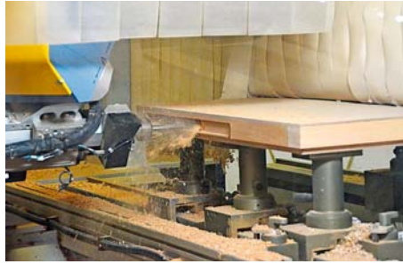
/ Die Maka PE 90 bietet großzügige Bearbeitungsmaße von 6000 x 1600 x 300 mm (X-, Y-, Z-Richtung).
